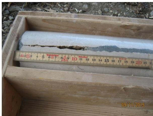
Bild 2 Bohrkern im Scheitelbereich des Natursteinbogens
