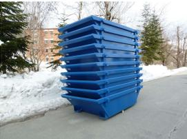
MINI-NORMALMULDE 1,5 M3<br>alles vollverschweisst<br>grundiert und lackiert in RAL nach Wunsch<br>Boden 3 mm / Wände 3 mm<br>Ecken verstärkt<br>starkes Abschlussprofil bei Nocken<br>Eigengewicht 235 kg<br>Aussenlänge 2500 mm<br>Aussenbreite 1490 mm mit Nocken<br>Aussenhöhe 570 mm                                                                                                                                                                       | 1     | Stk.  | 890.00   | 890.00     |
