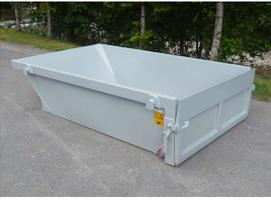
MINI-TORMULDE 1,5 M3<br>alles vollverschweisst<br>grundiert und lackiert in RAL nach Wunsch<br>Boden 3 mm / Wände 3 mm<br>Ecken verstärkt<br>Hinterladen abklappbar<br>starkes Abschlussprofil bei Nocken<br>Gewicht 305 kg<br>Aussenlänge 2500 mm<br>Aussenbreite 1450 mm mit Nocken<br>Aussenhöhe 570 mm                                                                                                                                                     | 1     | Stk.  | 990.00   | 990.00     |
