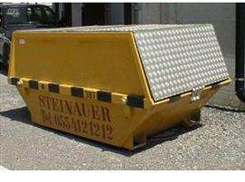
MINI-STADTMULDE 3 M3<br>alles vollverschweisst<br>grundiert und lackiert in RAL nach Wunsch<br>Boden 3 mm / Wände 3 mm<br>Ecken verstärkt<br>Aluriffeldeckel, abschliessbar<br>mit Regenwasserrinne<br>starkes Abschlussprofil bei Nocken<br>und starkes Abschlussprofil oben<br>Gewicht 320 kg<br>Aussenlänge 2500 mm<br>Aussenbreite 1490 mm mit Nocken<br>Aussenhöhe 1200 mm<br>Einwurfhöhe 570 mm<br>(Stapelung ist aus Sicherheitsgründen nicht zulässig) | 1     | Stk.  | 1'690.00 | 1'690.00   |
