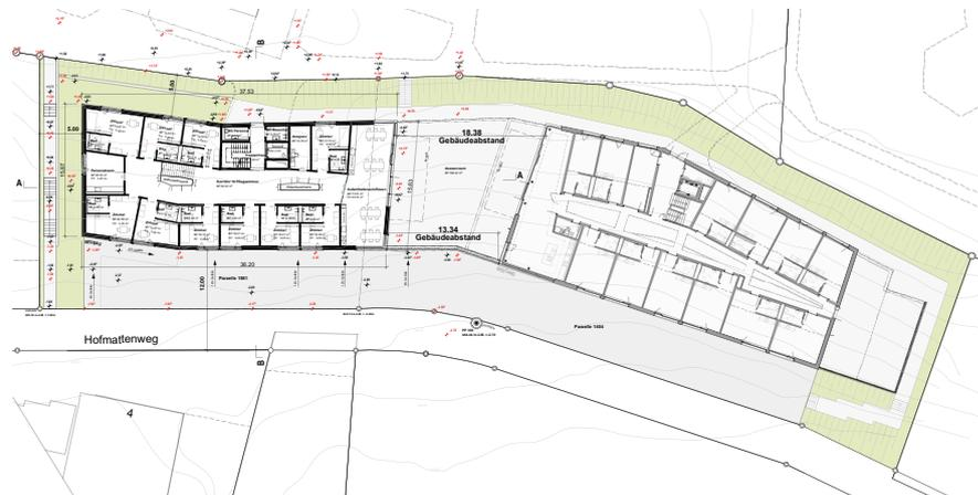
Abb. 4 Situation Vorprojekt mit möglichem Gebäudegrundriss innerhalb der Baubereiche für den Sockelbau und für die Hauptgebäude.
